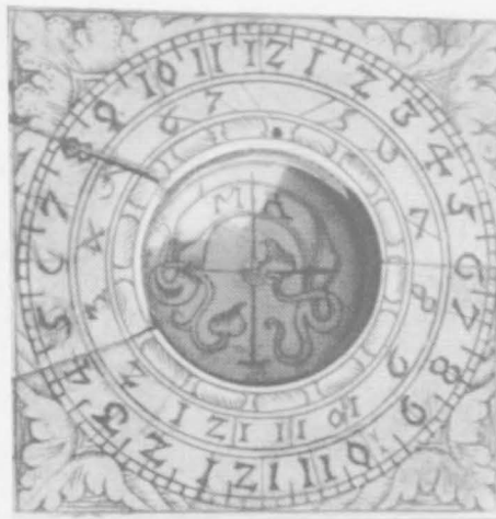
Setzkompaß und Sonnenuhr kombiniert. Holz und graviertes Elfenbein. M-A bedeutet Morgen (= Osten) — Abend (= West) — Miner's compass and sundial. The M-A means Morning-Evening, (or East-West) — Boussole de mine Tyrolienne, combinée avec cadran solaire. Le M-A veut dire Est-Ouest
